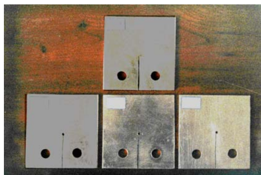
شکل (۷). نمونه‌های CT قبل از آزمایش در دستگاه کشش
