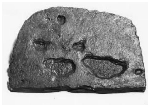
شکل ۳: خوردگی بدنه کشتی توسط SRB پس از تنها ۹ ماه
