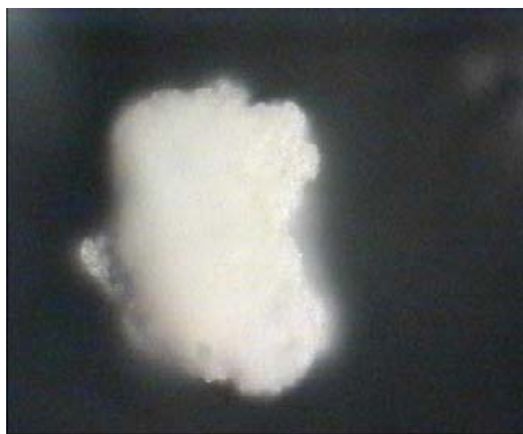
شکل شماره ۶ تکه کنده شده از کاسه نمد با بزرگنمایی
